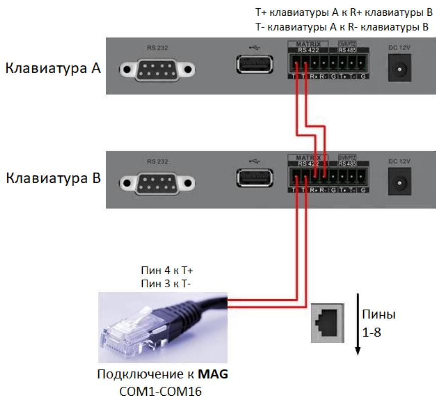
Рисунок 4-12 Подключение между каскадированными клавиатурами и MAG
