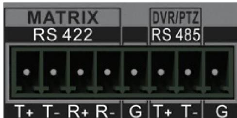
Рисунок 4-15 Последовательный порт RS-485
